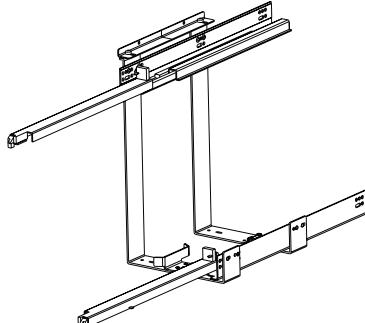
**El ensamble de las correderas y la guía de madera de las correderas deben estar en contacto para asegurar adecuadamente la unidad de madera al juego de correderas. Si esto se hace incorrectamente, los componentes eléctricos se podrían dañar.**
